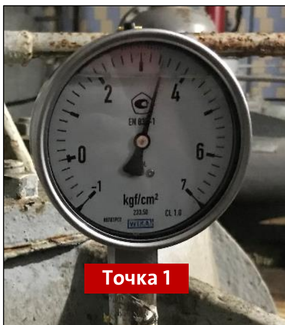
Рисунок 2.5 - Показания манометров при подаче 1200 м 3 /ч
