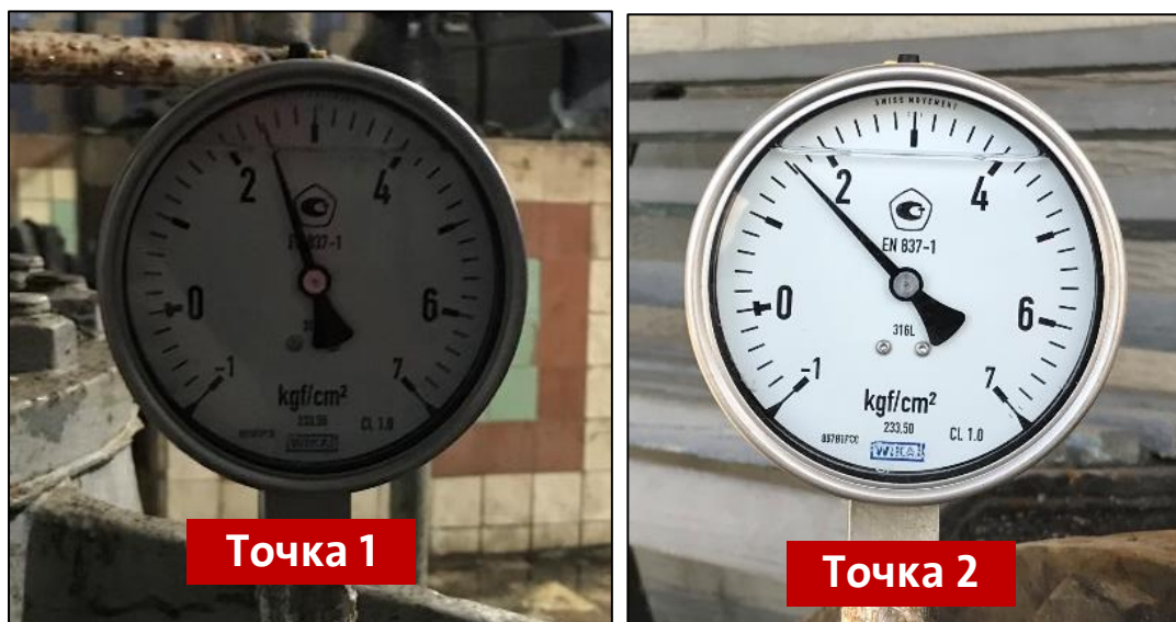
Рисунок 2.6 - Показания манометров при максимальной подаче 2100 м³/ч
