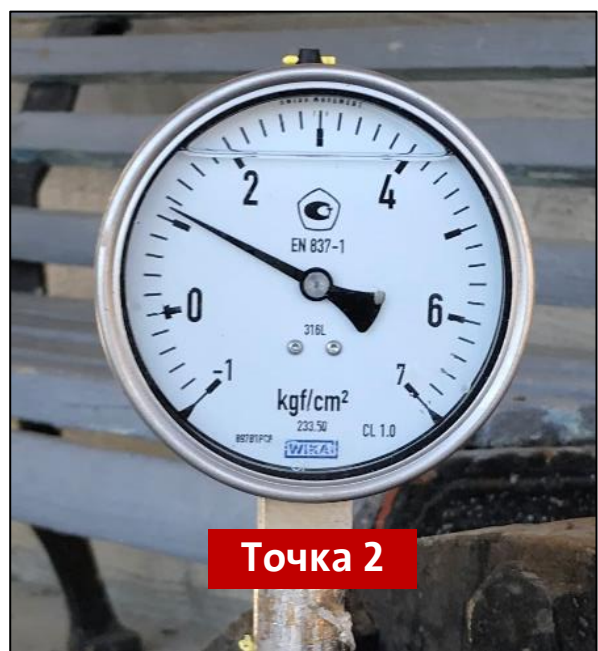
Рисунок 2.5 - Показания манометров при подаче 1200 м 3 /ч
